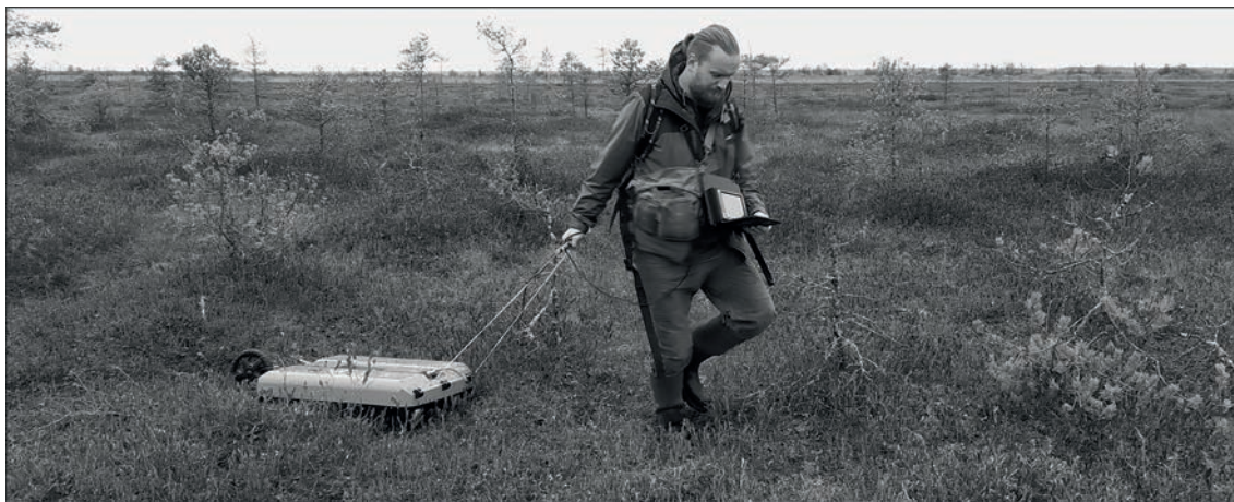
Рис. 2. Фотография процесса выполнения георадарной съемки.
