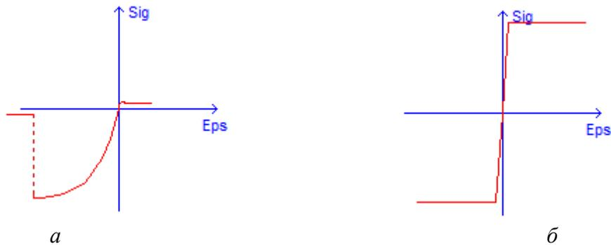
**Рис. 3.** Диаграммы для бетона (а) и стальной арматуры (б) в ПК ЛИРА-САПР
