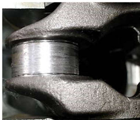
Рис. 2. Шатунная шейка Fig. 2. Connecting rod neck
