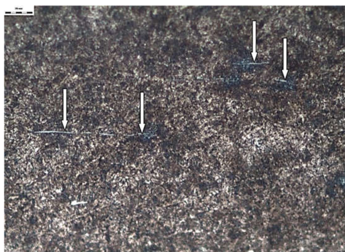
Рис. 7. Микроструктура третей шатунной шейки Fig. 7. Microstructure of the third crankpin
