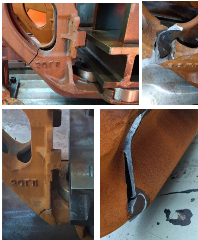
Рис. 4. Характер усталостного разрушения БР при статических испытаниях
