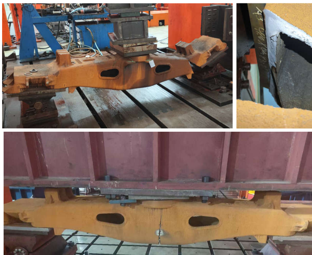
Рис. 3. Характер усталостного разрушения НБ при статических испытаниях
