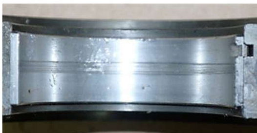
Рис. 1. Вкладыш коренного подшипника Fig. 1. Main bearing insert
