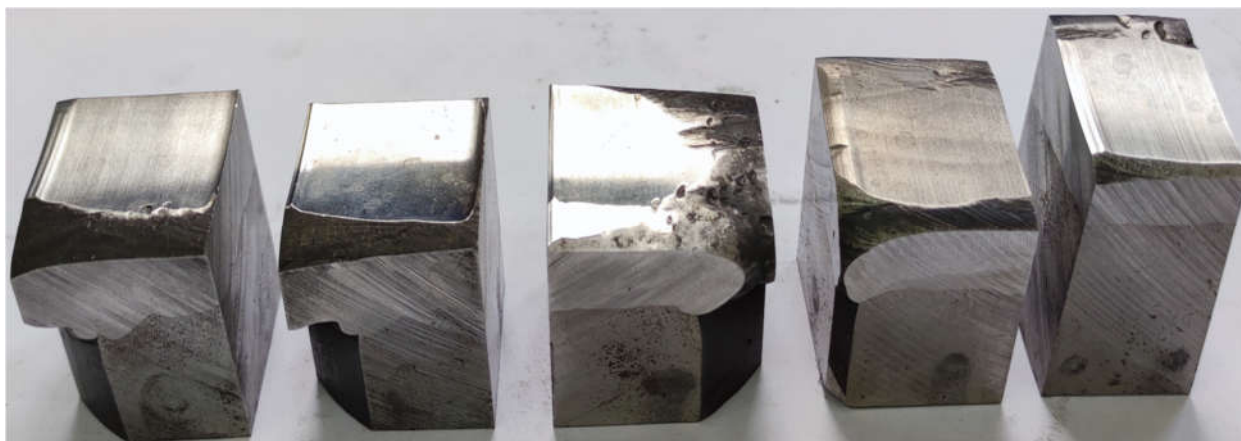
Рис. 7. Фото образцов после абразивного износа (нумерация составов слева направо) Fig. 7. Photos of samples after abrasive wear (composition numbers from left to right)
