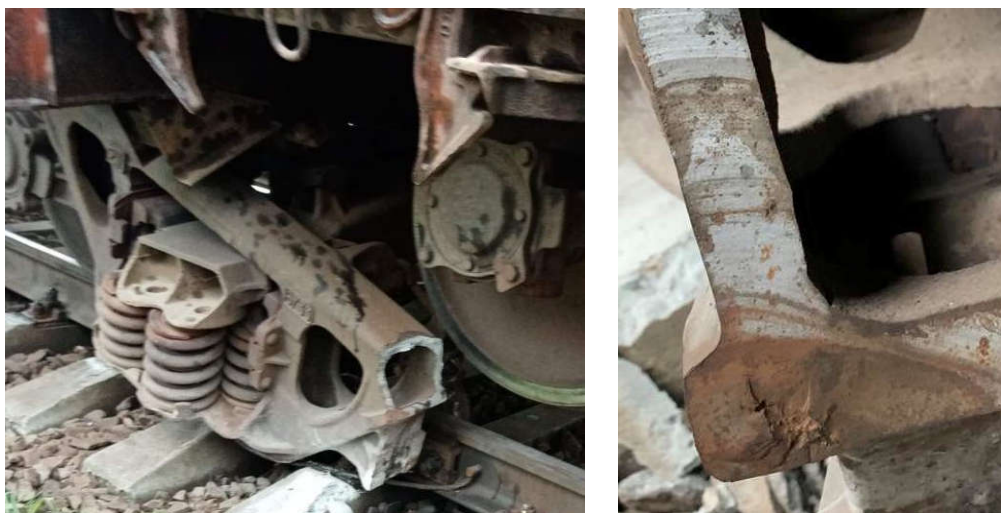
Рис.1. Излом БР в зоне внутреннего угла буксового проема из наличия пор на глубине \geq 2 мм Fig. 1. Fracture of the side frame (SF) in the area of the inner corner of the axle box opening due to the presence of pores at a depth of \geq 2 mm
