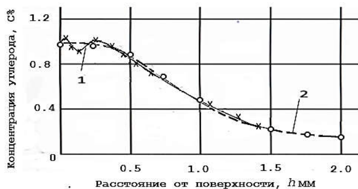
Рис. 3. Концентрационные кривые углерода: 1 – экспериментальная; 2 – расчетная Fig. 3. Carbon concentration curves: 1 – experimental; 2 – calculated
