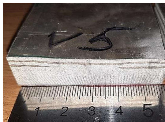
Рис. 3. Макрошлиф композиционного материала
