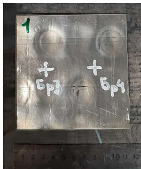
Рис. 7. Внешний вид подготовленного для испытания на пулестойкость экспериментального образца композиционного броневых материала The appearance of an experimental sample of composite armor material prepared for testing for bullet resistance
