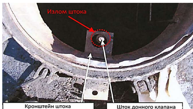
Рис. 1. Пример перелома верхней части штока донного клапана железнодорожной цистерны Fig. 1. Example of fracture of the upper part of the bottom valve stem of a railway tank
