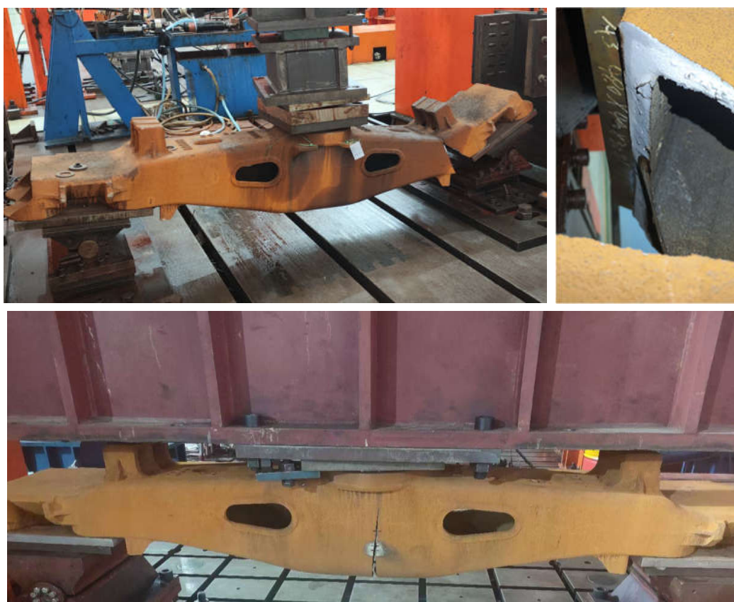
Рис. 3. Характер усталостного разрушения НБ при статических испытаниях
