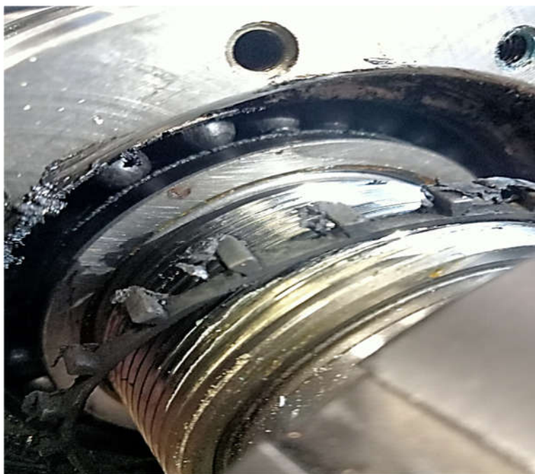
Рис. 3. Разрушенный подшипник задней опоры Fig. 3. Destroyed rear support bearing
