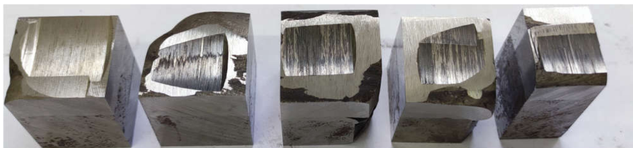
Рис. 14. Фото образцов после истирания в условиях трения скольжения (нумерация составов слева направо) Fig. 14. Photos of samples after abrasion under sliding friction conditions (composition numbers from left to right)
