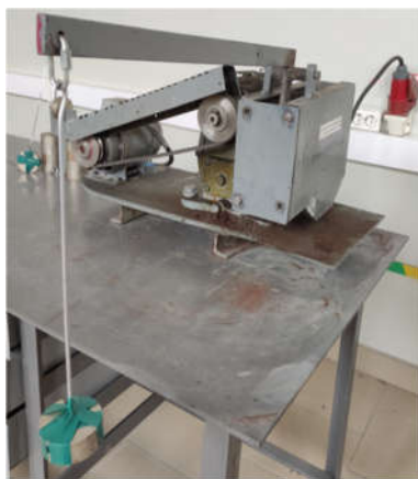
Рис. 2. Внешний вид установки для испытаний на абразивный износ по схеме Бринелля-Ховарта Fig. 2. Appearance of a Brinell-Haworth abrasive wear test rig
