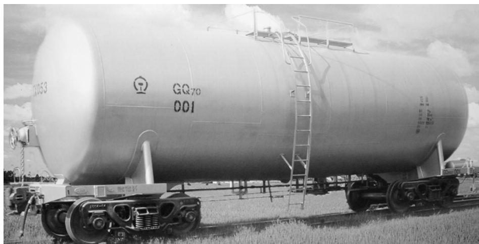
Рис. 9. Безрамная цистерна производства Китая Fig. 9. Frameless tank made in China
