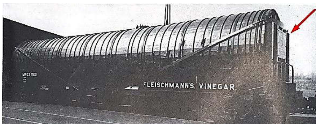
Рис. 8. Американская цистерна, снабжённая торцевыми стенами. Fig. 8. American tank equipped with end walls
