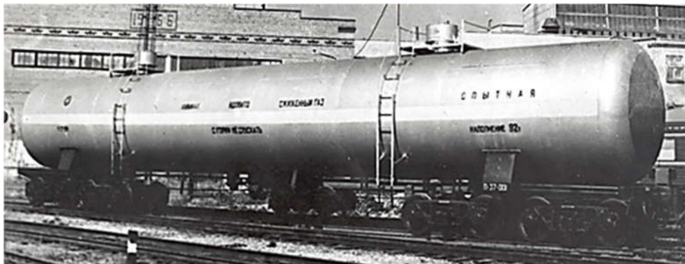
Рис. 5. Опытная восьмиосная безрамная цистерна для сжиженного газа (аммиака) Fig. 5. Experimental eight-axle frameless tanker for liquefied gas (ammonia)
