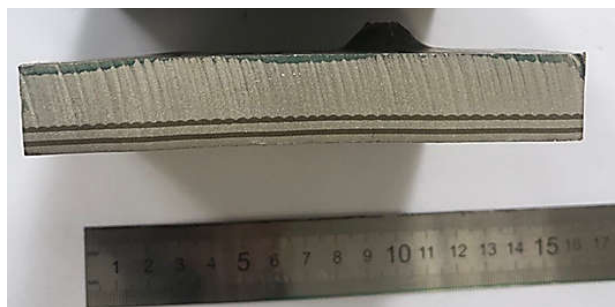
Рис. 9. Результат оценочных испытаний по классу защиты по пулестойкости Бр3 и Бр4 по ГОСТ 34286-2017 (вид сбоку) Fig. 9. The result of evaluation tests for the bullet resistance class Br3 and Br4 according to GOST 34286-2017 (side view)
