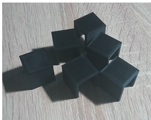
Рис. 1. Заготовки из акрилонитрил-бутадиен-стирола Fig. 1. Acrylonitrile butadiene styrene workpieces
