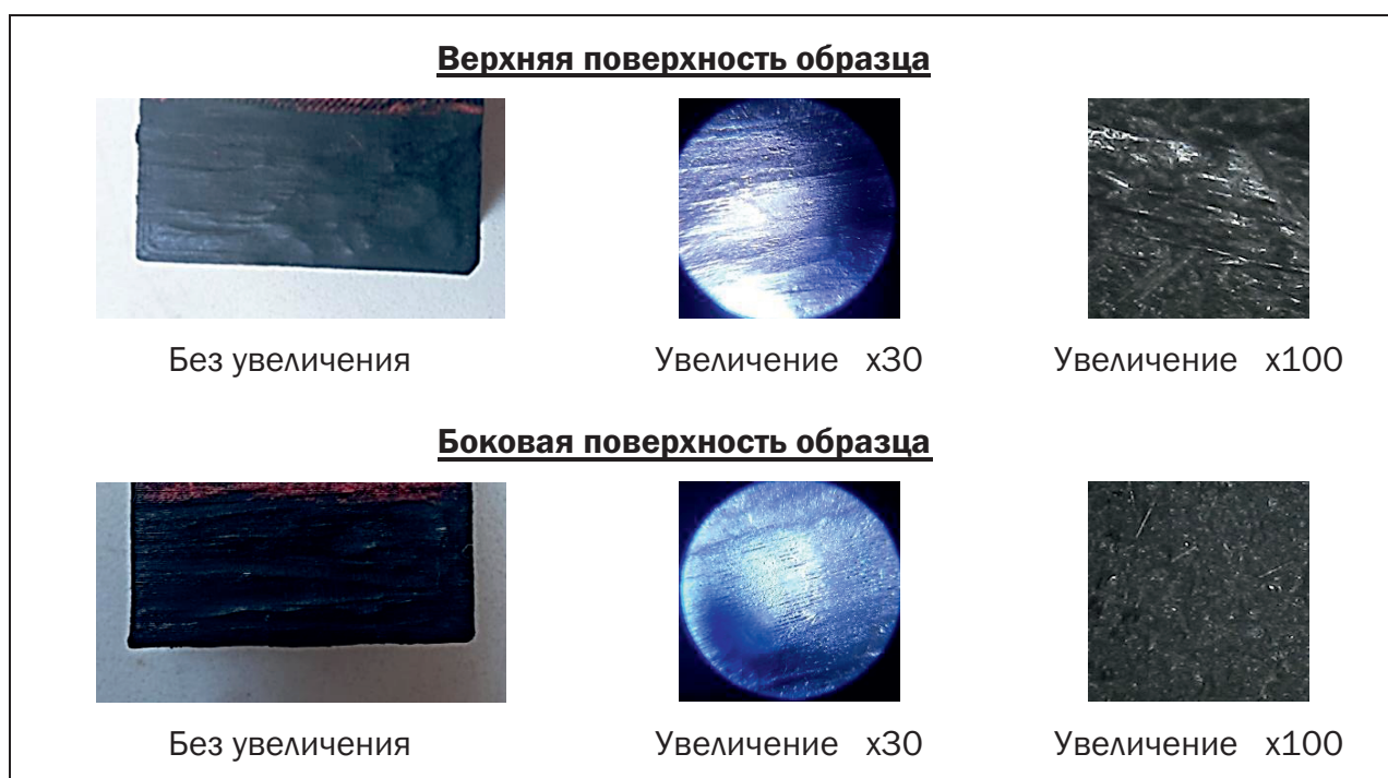
Рис. 6. Часть заготовки, обработанная полировальным кругом с абразивной пастой
