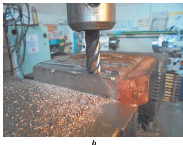
Рис. 2. Фото заготовки детали с наплавленным высокотвердым слоем (а) и фото обработки высокотвердого слоя с глубиной резания 1,5 мм четырехзубой монолитной твердосплавной фрезой диаметром 10 мм (б)
