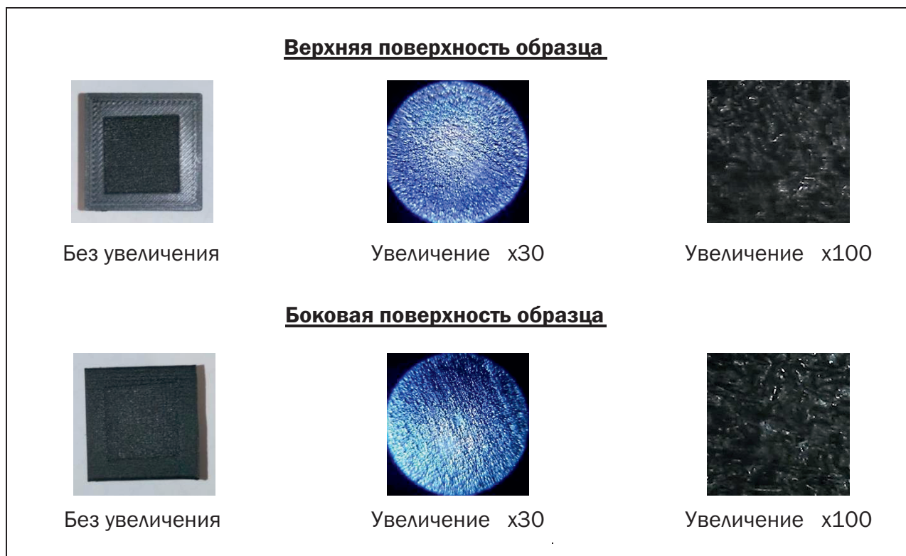
Рис. 13. Заготовка, обработанная лазерным излучением Fig. 13. Laser treated workpiece
