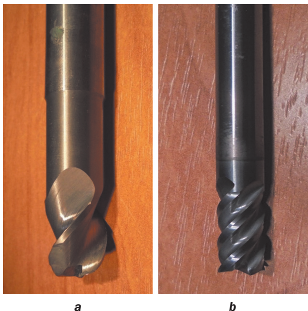
Рис. 1. Фото фрез (США): а – двухзубая фреза с винтовой канавкой (модель T73748QTA Z161A 10mm16c 50L0751RTA 4FL STUB Z-CARB); б – четырехзубая фреза с крутой винтовой канавкой (модель 9FL GUTTER 16mm x 92mm 30RTA)
