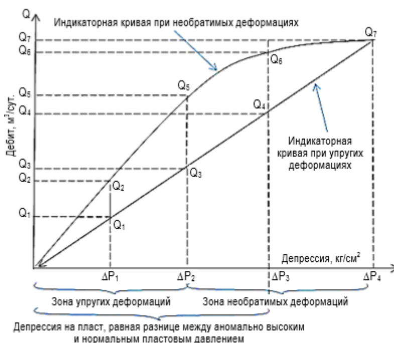
Рис. 1. Изменение зависимости дебита от депрессии по материалам М.Д. Белонина, 2005 Fig. 1. Variation of well flow rate dependence on differential pressure drawdown based on M.D. Belonin's materials, 2005
