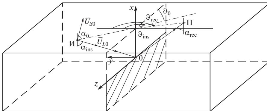
Рис. 1. Схема прозвучивания изделия с трещиной (заштрихована).
