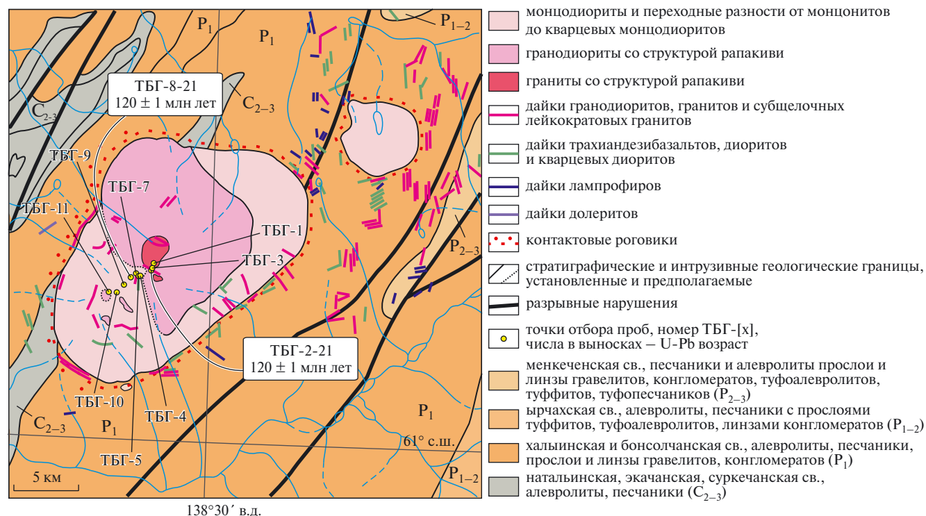
Рис. 2. Схема геологического строения Тарбаганнахского массива, составленная с использованием [8, 11].
