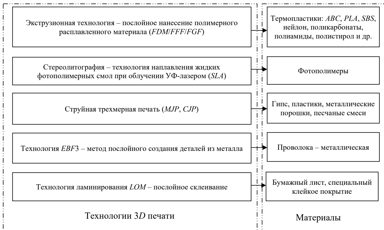
Рис. 1. Основные технологии 3D печати и материалы Fig. 1. Basic 3D Printing Technologies and Materials
