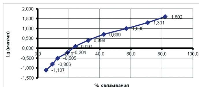
Рисунок 1. Калибровочная кривая для определения кратности снижения антигенности в гидролизатах БКМ
