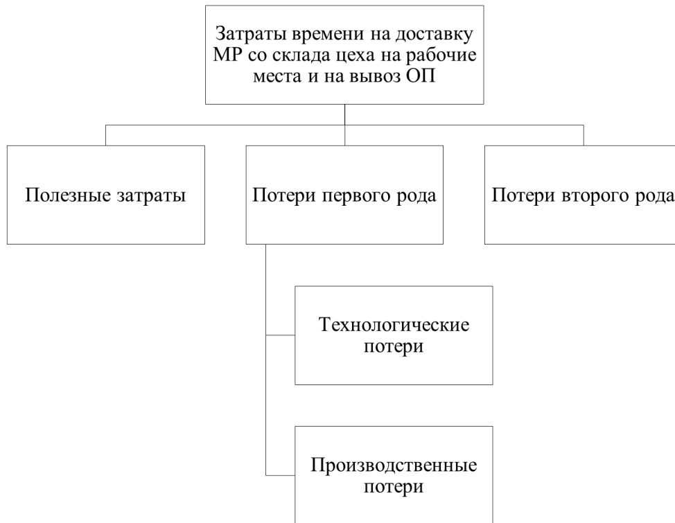
Рис. 3: Классификация затрат времени на реализацию процессов доставки материальных ресурсов со склада цеха на рабочие места и вывоз отходов производства
