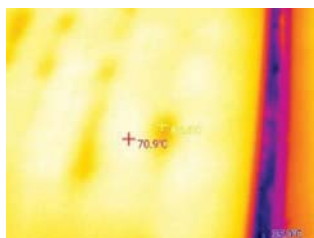
Рис. 5. Инфракрасный снимок нагрева солнечного модуля JKM-230-P60
