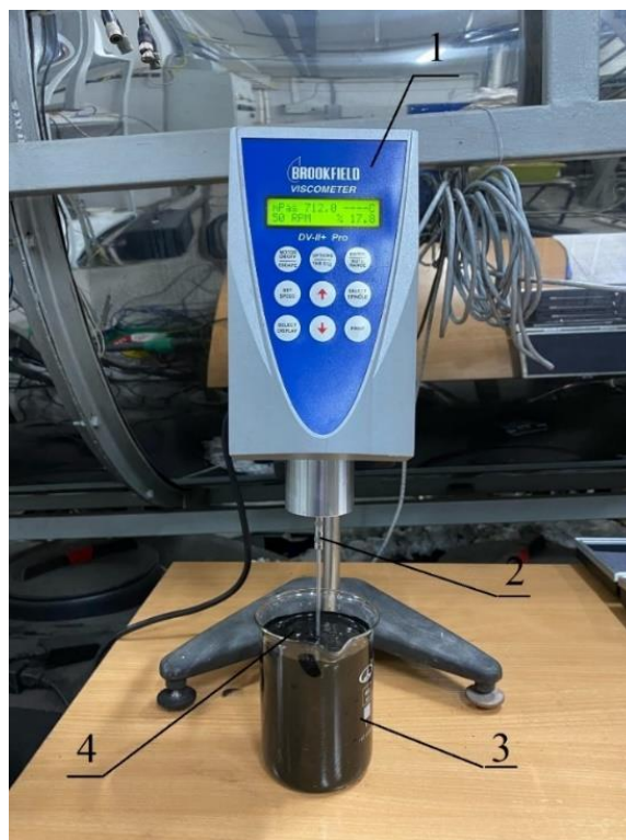
Рис. 1. Экспериментальная установка по измерению динамической вязкости ВУС (1 – ротационный вискозиметр; 2 – шпиндель; 3 – цилиндрический стеклянный сосуд с исследуемой суспензией; 4 – Био-ВУС)
