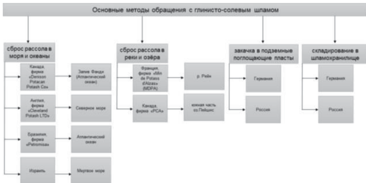
Рис. 4. Управление глинисто-солевым шламом Fig. 4. Management of clay-salt slurry
