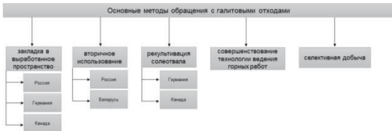
Рис. 5. Управление галитовыми отходами Fig. 5. Management of halite waste
