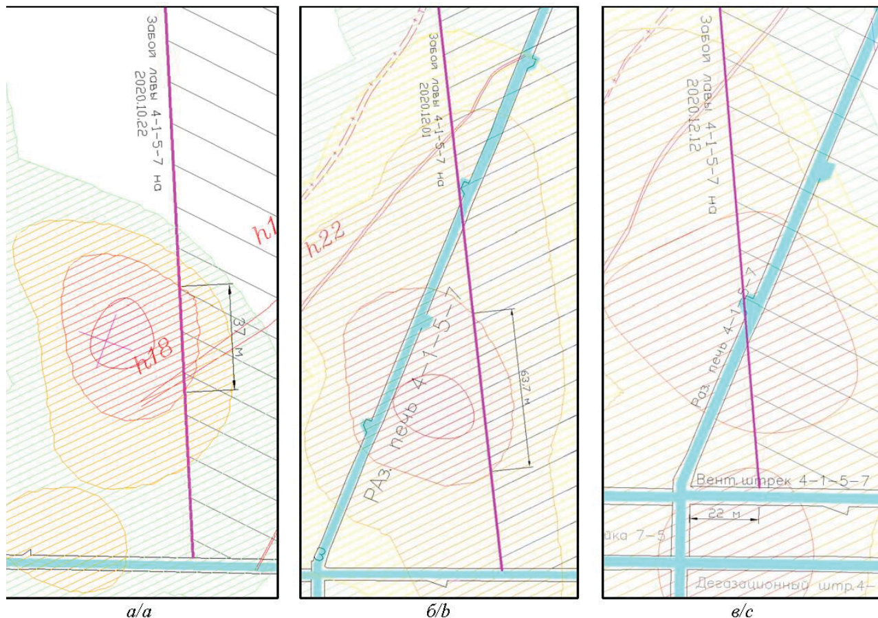
Рис. 4. Параметры зоны повышенного сейсмозергосвыделения в выработке при переезде забоем лавы: а) группы тектонических нарушений; б) передовой выработки; в) в вентиляционном штрехе 4-1-5-7 (Палитра для окрашивания зон по параметру F соответствует табл. 3)
