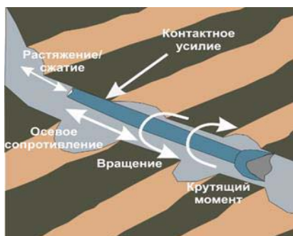
Рис. 14. Определяющие силы, действующие на бурильную трубу в криволинейной области скважины
