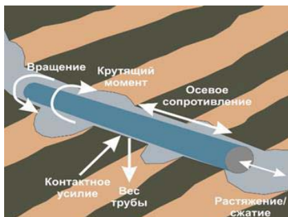
Рис. 13. Определяющие силы, действующие на бурильную трубу на преимущественно наклонном участке скважины
