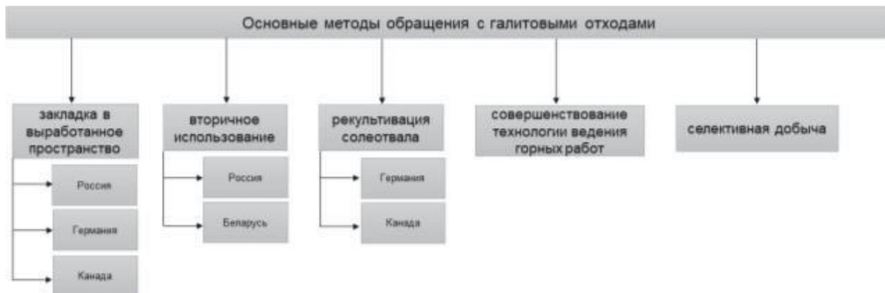
Рис. 5. Управление галитовыми отходами
