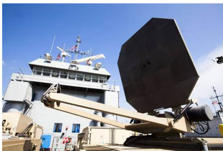
Рис.5 Опытный образец «микроволновой пушки» в стационарном варианте, устанавливаемой на морских судах (фото с сайта DefenseTech.org)
