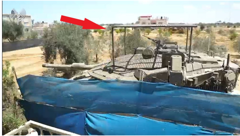
Рисунок 6. Израильский танк «Merkava» с первоначальным вариантом антидроновой защиты, начало операции в Рафахе.
