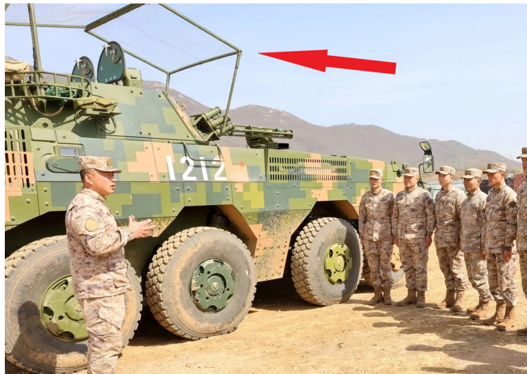
Рисунок 8. Китайский БТР ZBD-09 на соревнованиях с наваренным антидроновым козырьком.
