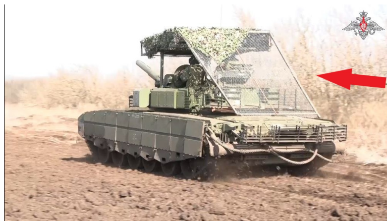
Рисунок 4. Российский танк с заводским козырьком и дополнительной кустарной защитой из сетки рабицы.
