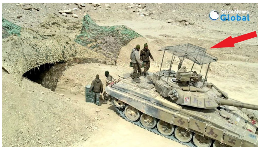
Рисунок 9. Индийский танк Т-90 с антидроновым козырьком.
