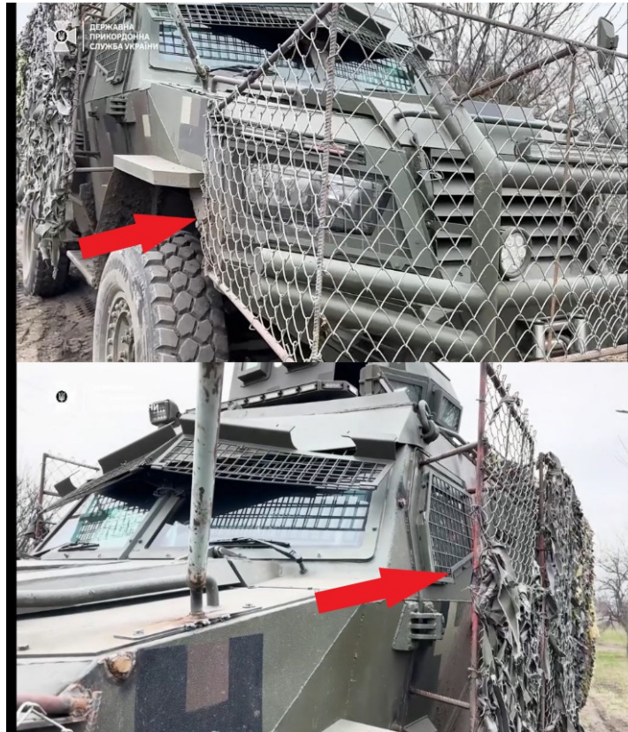
Рисунок 5. Канадский броневлаomobilь «Roshel» ГПСУ с кустарной антидроновой защитой из сетки рабицы.
