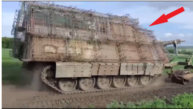
Рисунок 11. Российский танк со сверхтяжелой антидроновой кустарной наваренной защитой.
