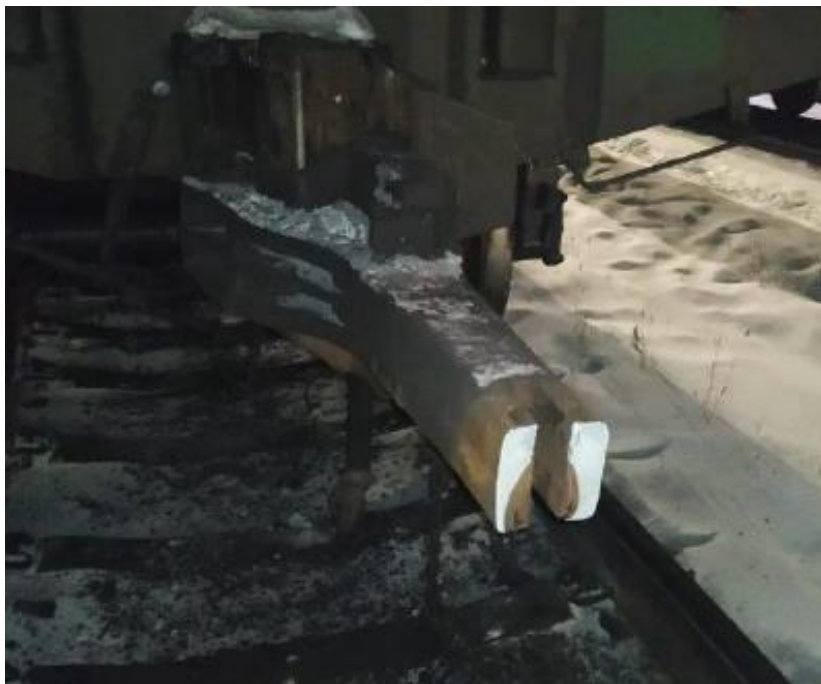
Рисунок 7 – Пример разрушения корпуса автосцепки от действия сверхнормативных продольных сил
