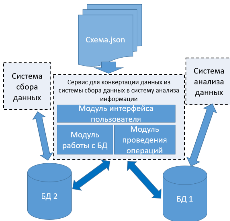
Рисунок 1 – Схема сервиса для обработки и передачи данных
