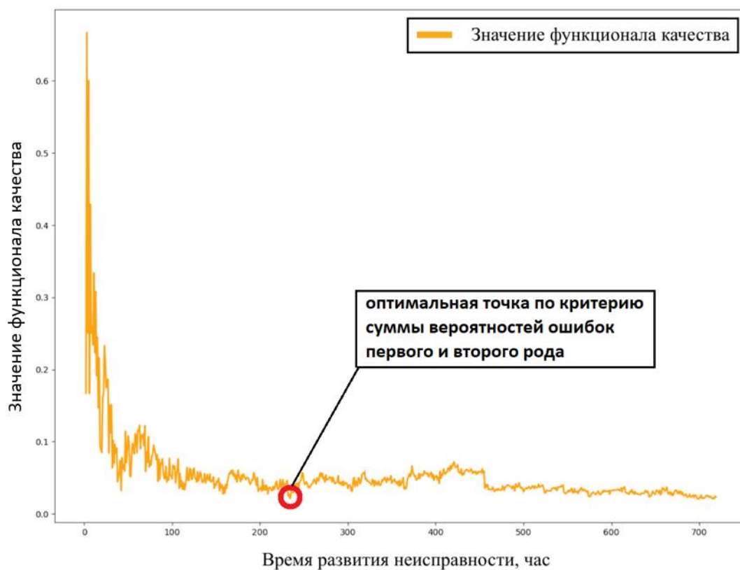
Рисунок 5 – Значение функционала качества в зависимости от параметра T
