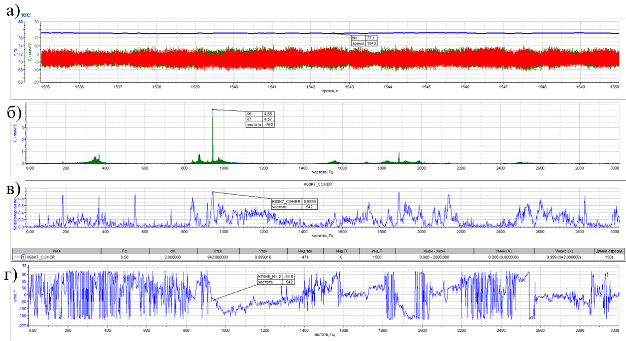
Рисунок 13 – Осциллограмма (а) и спектрограмма (б) с корневых т/д лопаток №7 и №8 РК 1-й ступени, функция когерентности (в) и график сдвига фаз (г) в момент автоколебаний (работа с интерцептором, имитирующим полётные условия при P_{\text{вх}}^* = 1,3 \text{ кг/см}^2 , T_{\text{вх}}^* = 100^\circ\text{C} , при \delta K p_{1\text{cm}} = 9,2\% на режиме n_{\text{лп}} = 70\% )
