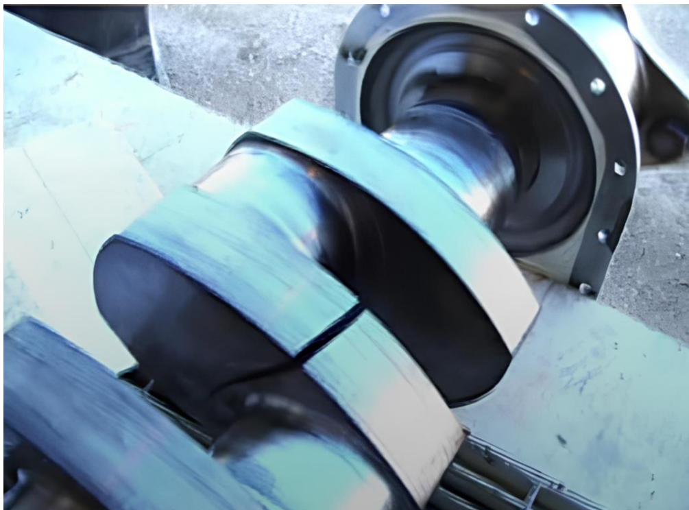
Рисунок 4 – Усталостное разрушение коленчатого вала
