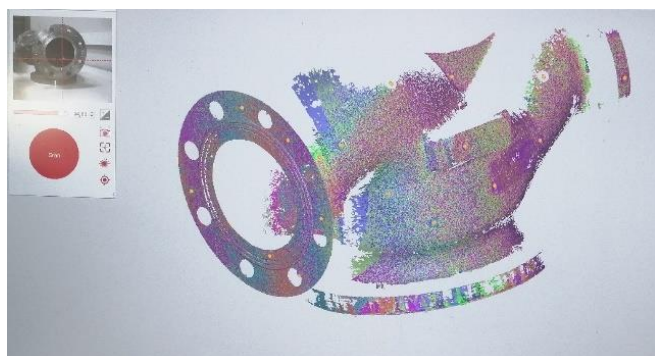
Рисунок 3 – 3D-модель корпуса клапана: а – полигональная; б – математическая
