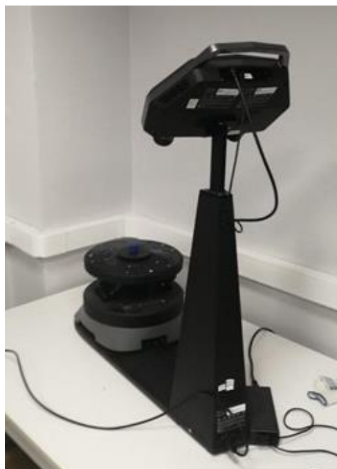
Рисунок 2 – 3D сканер Solutionix C500
