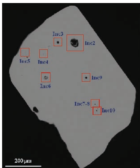
Рис. 1. Распределение включений в зерне самородного осмия (9902-1) из тяжелой фракции, Нижнесергинский район, Средний Урал.
