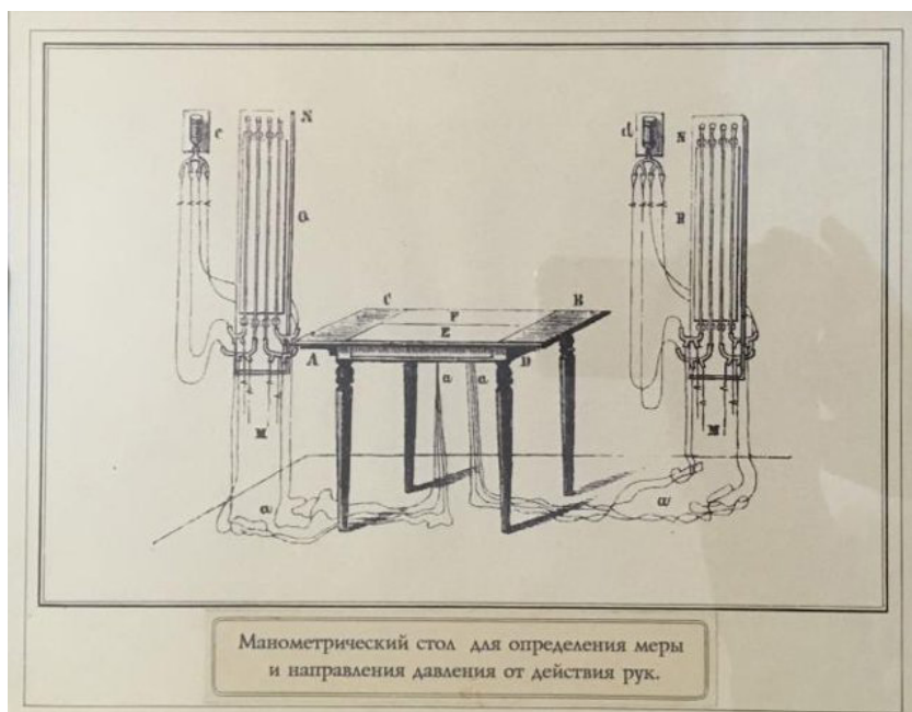
Ил. 2. Рисунок «Манометрический стол для определения меры и направления давления от действия рук» из «Материалов для суждения о спиритизме» Д. И. Менделеева. Экспонат музея ММ НВ-173
