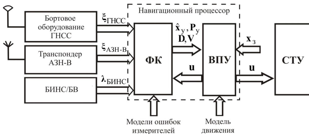
Рисунок 1 – Состав ИСН: СТУ – система траекторного управления; ФК – фильтр Калмана; ВПУ – вычислитель параметров управления
