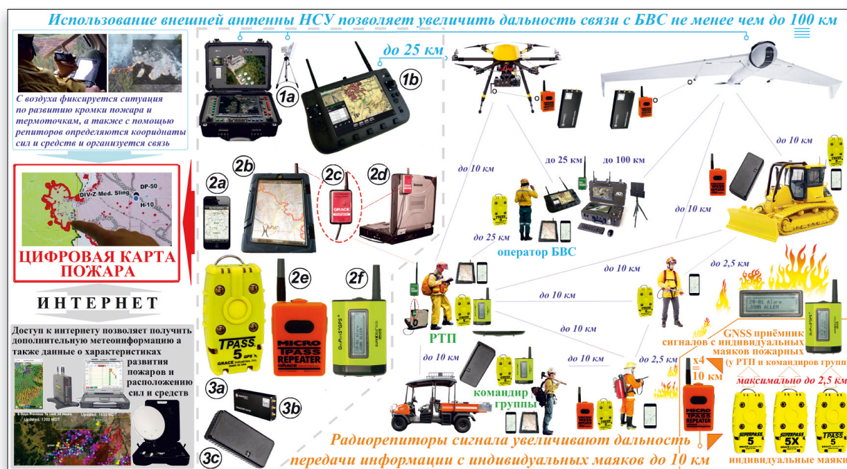
Рис. 2. Схема организация безопасности работ при тушении лесных пожаров с помощью современных технических средств в области навигации (GNSS-трекеры, а также устройства записи, обработки и отображения данных и др.).
