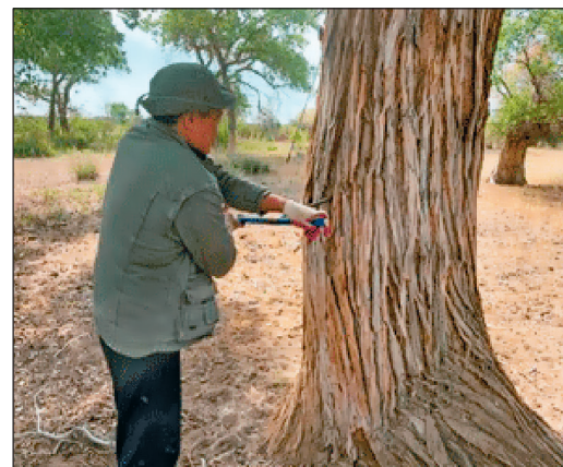
Рис. 6. Сбор образцов кернов туранги разнолистной на опытном участке в пойме р. Или.
