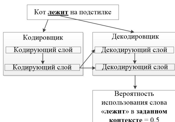
Рис. 4. Структурная схема сети «Трансформер». Каждый последующий кодирующий слой в кодировщике включает механизм внимания и позволяет формировать промежуточные признаки (векторные представления) все большей степени абстрактности
