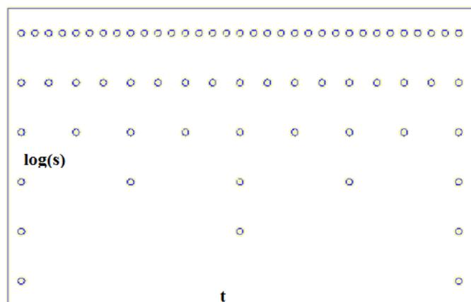
Рис. 7. Аналого-цифровое преобразование электрокардиосигнала на диадической сетке
