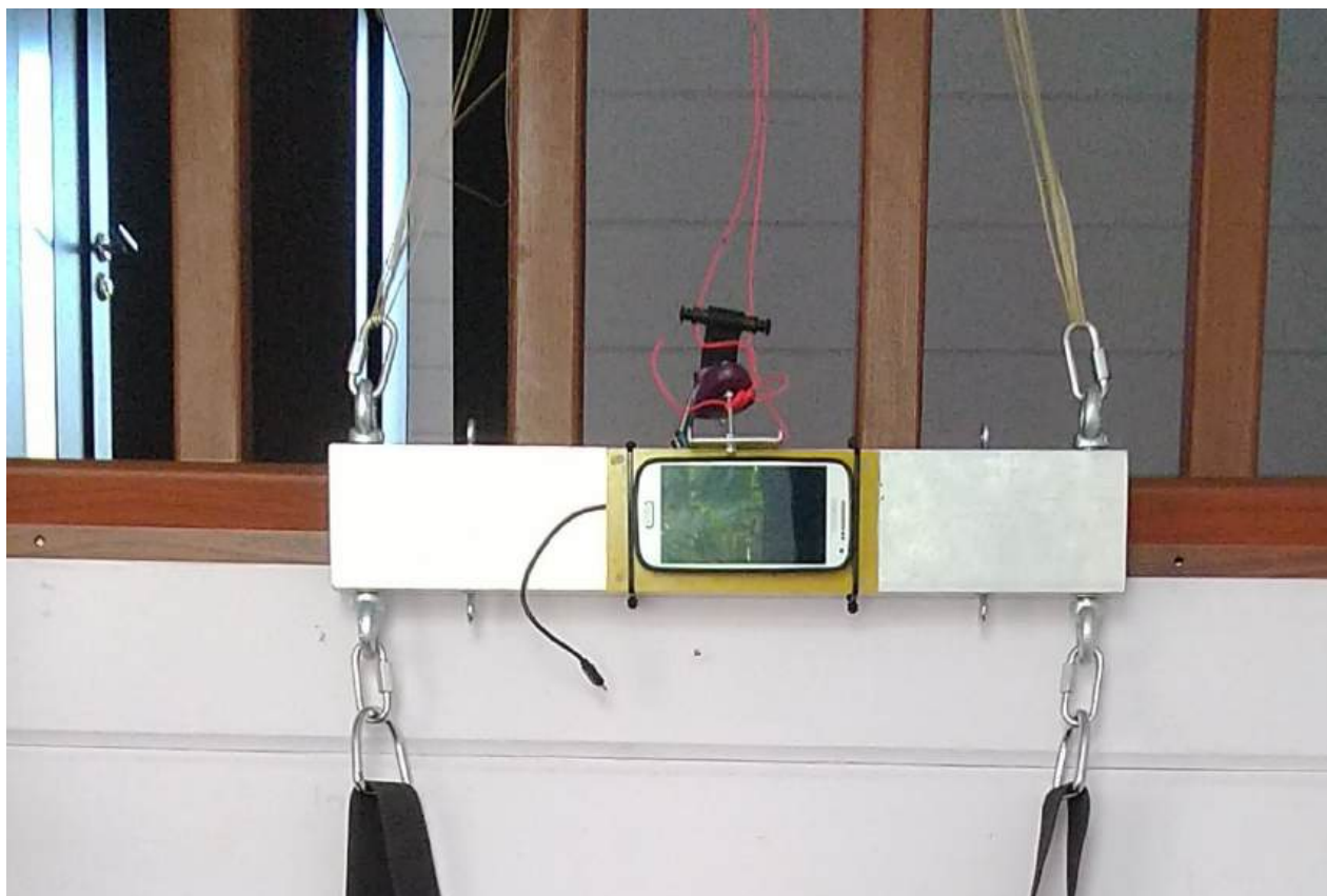
Рис. 1. Вариант конструкции дополнительного звена для измерения угла наклона равнодействующей аэродинамических сил
