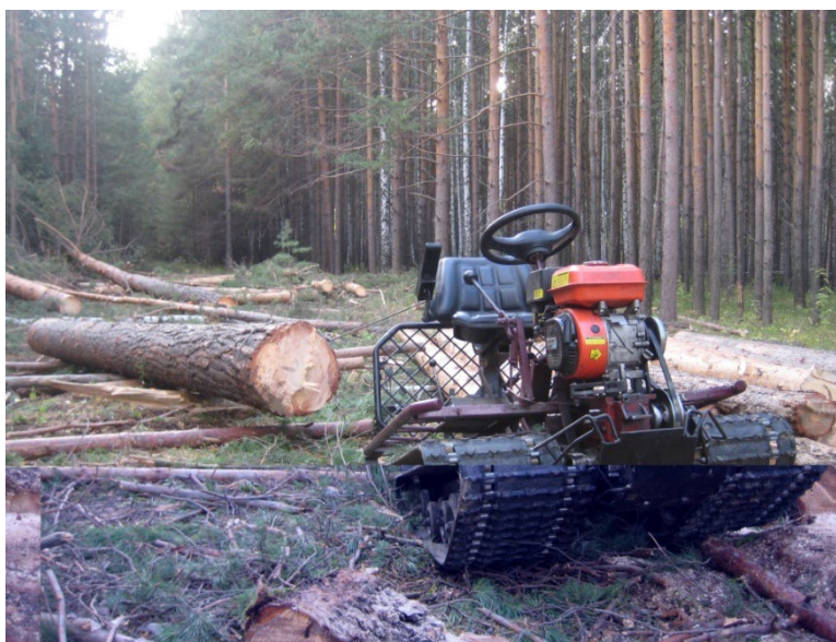
Фото 10. Трелёвка крупных сортиментов по подкладочным деревьям
