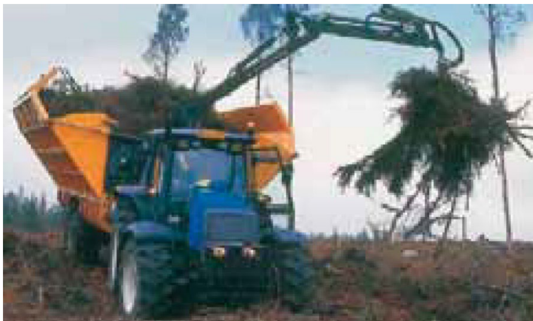
Фото 10. Машина для сбора и транспортировки порубочных остатков на базе сельскохозяйственного трактора марки Havu Hukka фирмы Vapo Oy [94]
