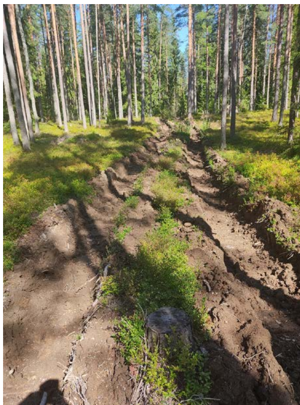
Фото 9. Глубокая колея, оставленная колёсной лесной машиной за один проход (Ленинградская обл., Выборгский р-н, 2022 г.)
