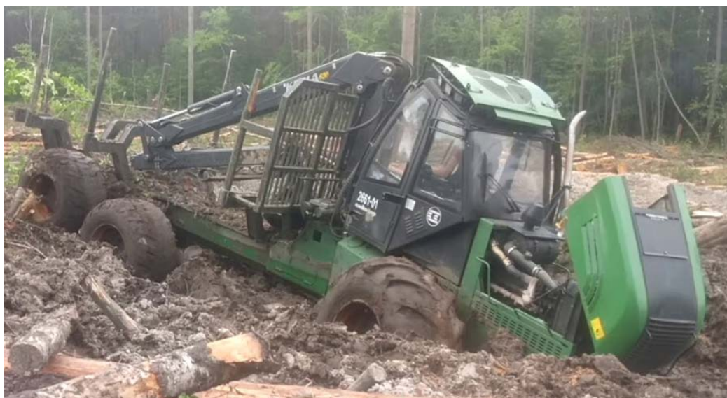
Фото 10. «Затопление» колёсного форвардера при плохих почвенно-грунтовых условиях
