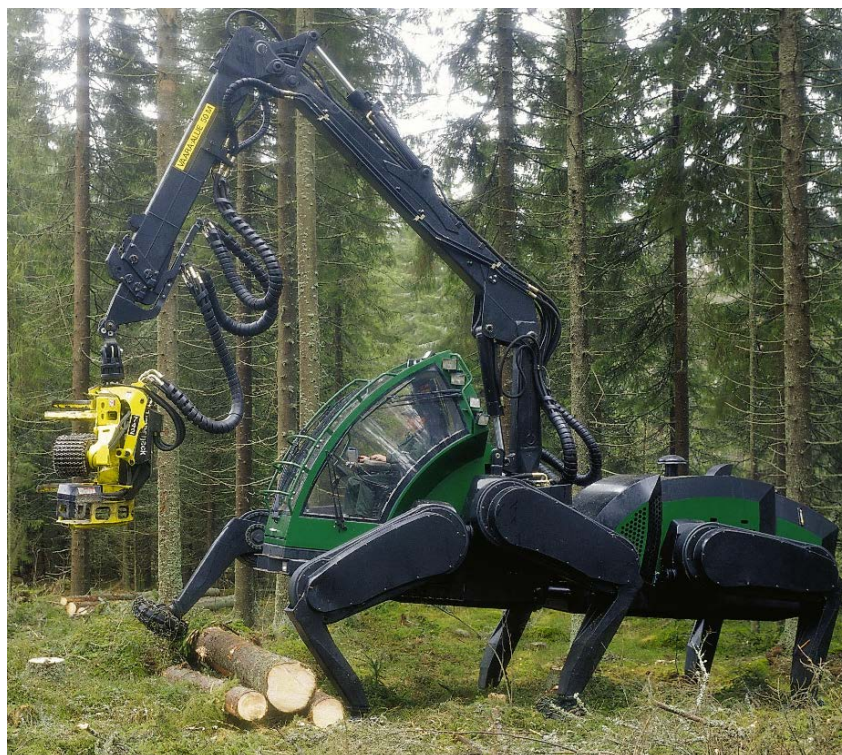
Фото 1. Харвестер с шагающим движителем компании Timberjack
