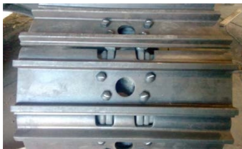
Лесной трак гусеничного харвестера (700 мм, два грунтозацепа)
