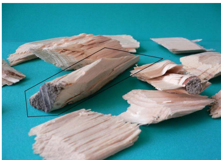
Фото 7. Крупная фракция щепы. Частица щепы с углом среза 12^\circ , получившаяся из короткомера (выделена)
