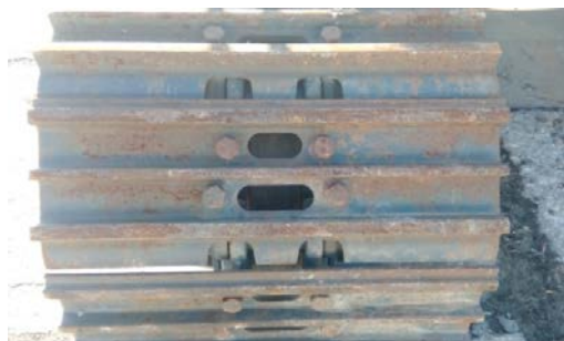
Заводской трак экскаватора (600 мм, три грунтозацепа)
