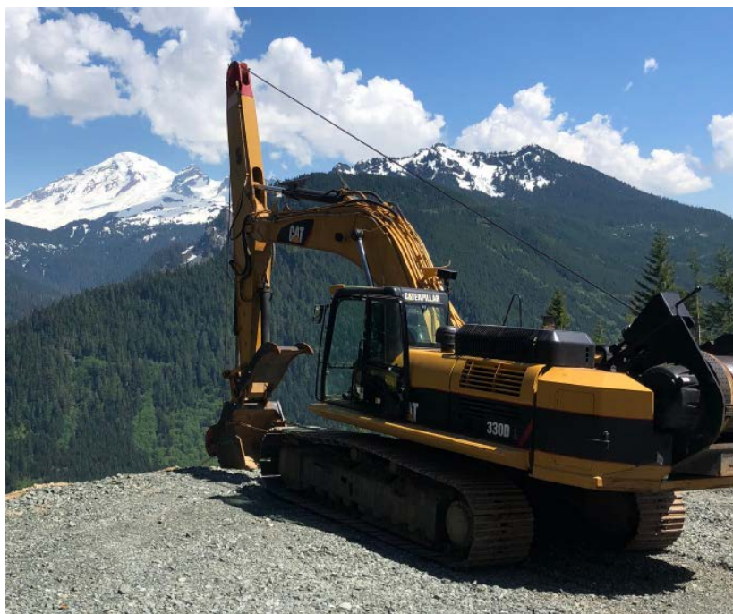
Фото 10. Самоходная лебёдка на экскаваторной базе Summit Winch Assist (фото с сайта U. S. FOREST SERVICE)
