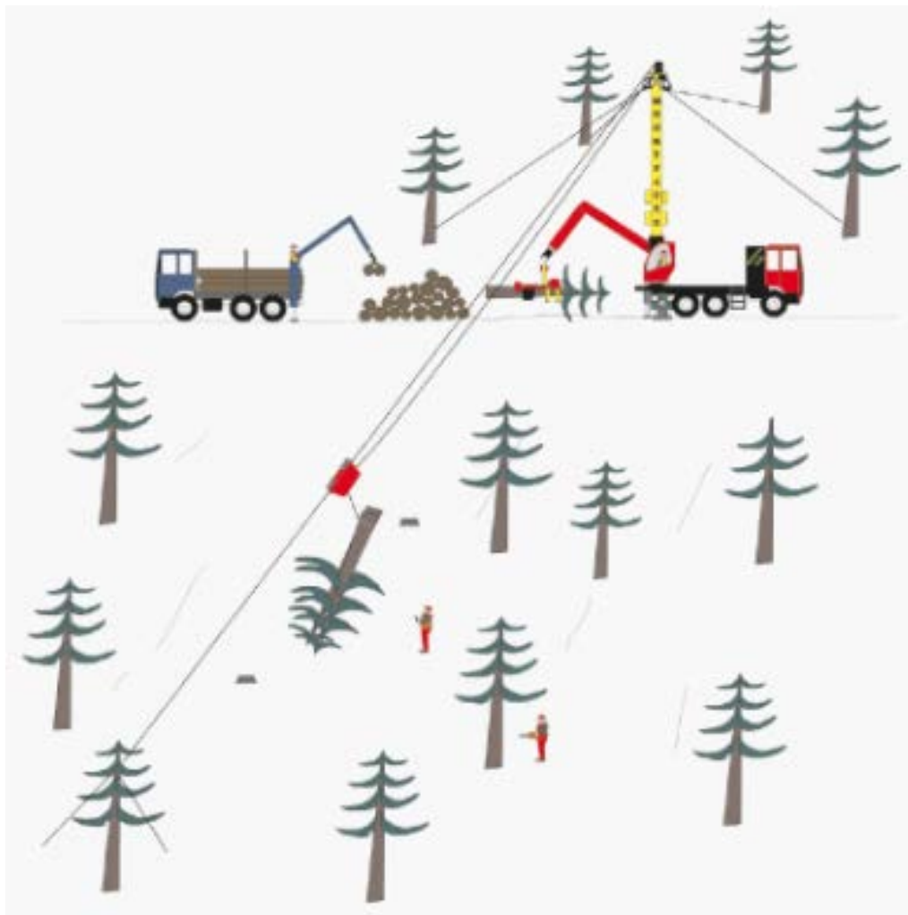
Рисунок 2. Схема работы горного процессора компании Konrad Forsttechnik GmbH (схема с сайта компании Konrad Forsttechnik GmbH)
