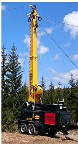
Фото 4. Мобильные КТУ компании Konrad Forsttechnik GmbH (фото с сайта компании Konrad Forsttechnik GmbH)
