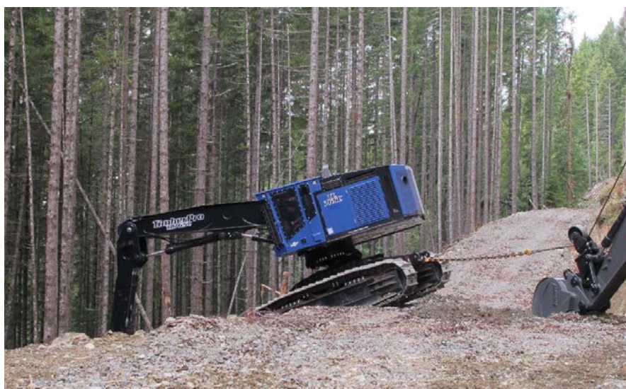
Фото 11. Валочно-пакетирующая машина спускается на горный склон, удерживаемая самоходной лебёдкой на экскаваторной базе Summit Winch Assist (фото авторов)
