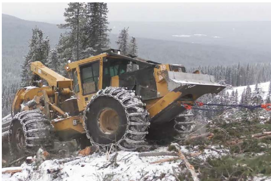
Фото 15. Работа скиддера на горном склоне в сцепке с самоходной лебёдкой (фото с сайта компании Ecoforst GmbH)
