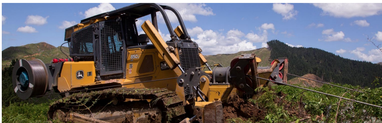
Фото 12. Самоходная лебёдка на бульдозерной базе ROB (фото с сайта компании Remote Operated Bulldozer)
