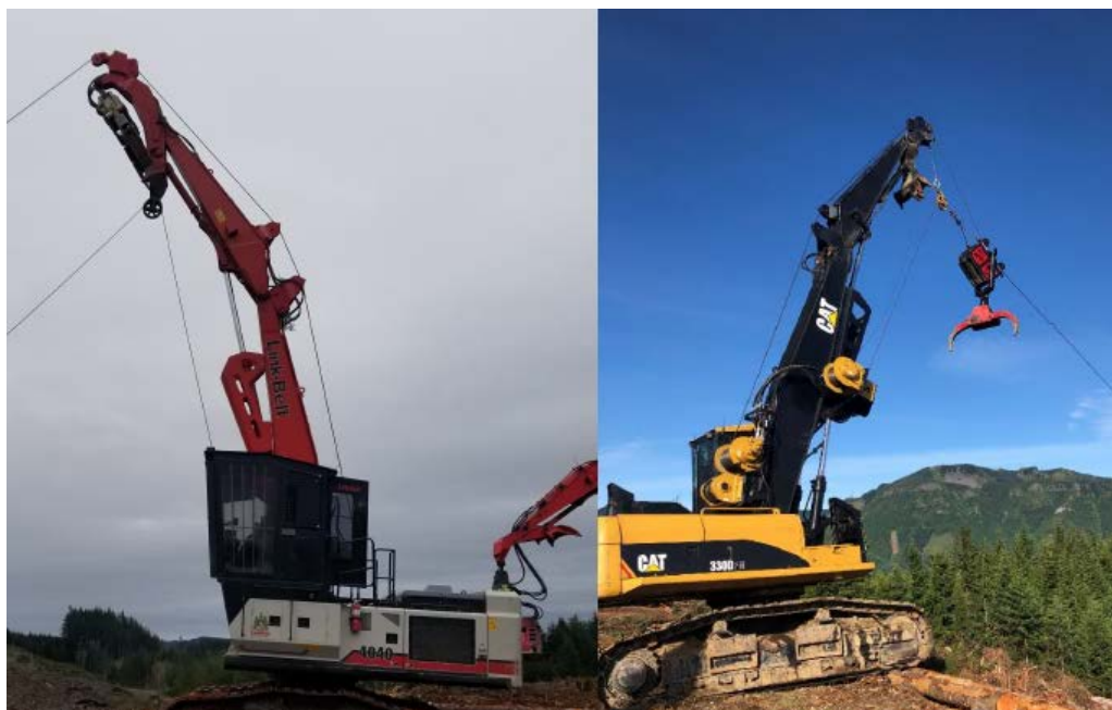
Фото 13. Мобильные КТУ на базе самоходных лебёдок на экскаваторной базе Summit Winch Assist Assist (фото с сайта U.S. FOREST SERVICE)
