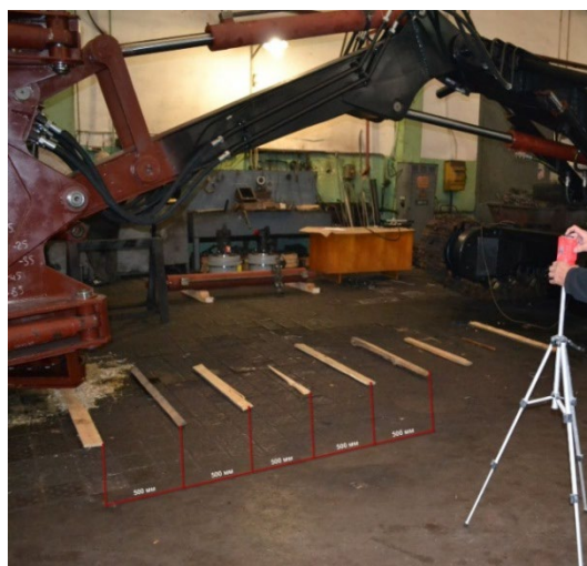
Фото 2. Горизонтальная мерная шкала на полу помещения (расстояние между индикаторами 500 мм) [фото автора]
