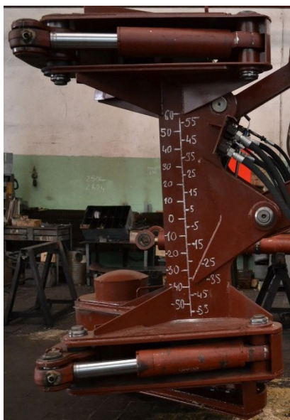
Фото 1. Контрастная вертикальная мерная шкала на ЗСУ ВПМ ЛП-19 [фото автора]
