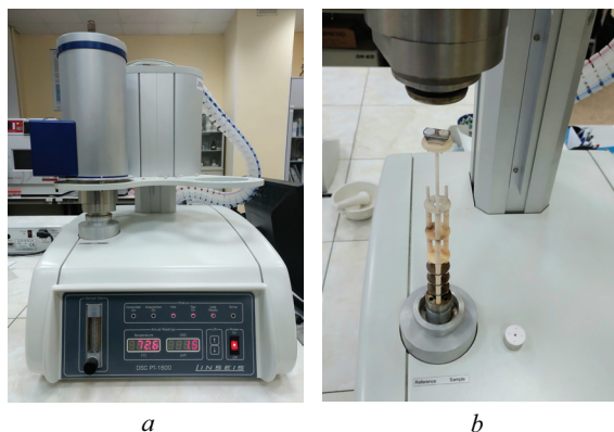
Рис. 1. Высокотемпературный дифференциальный сканирующий калориметр HDSC PT1600 Linseis DSC PT-1600 (a) с корундовой системой измерения (b)
