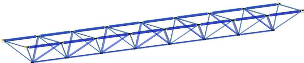
Рис. 6. Расчетная модель пролетной трехгранной фермы
