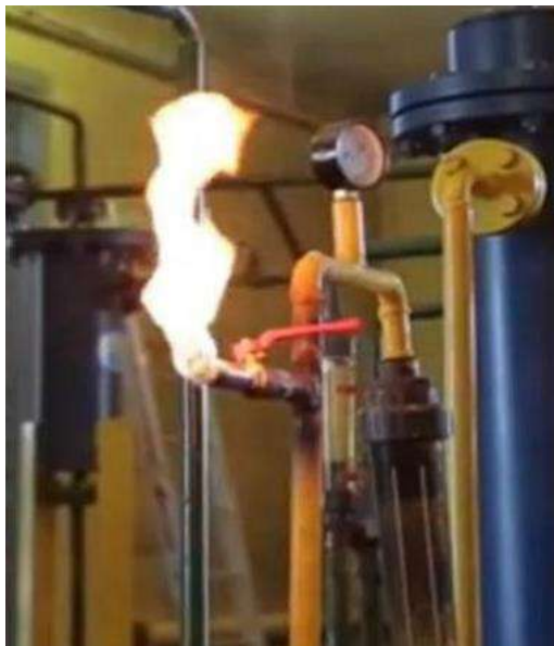
Рис. 3. Горение синтез-газа, образующегося в процессе термолиза
