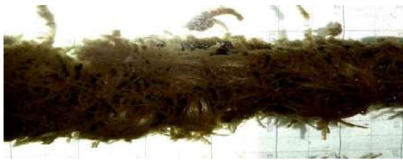
Рис. 2. Имобилизованный ил на ершовой загрузке
