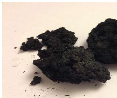
Рис. 2. Образец твердого остатка термолиза лигнина
