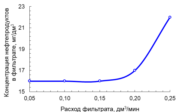
Рис. 1. Зависимость концентрации нефтепродуктов в фильтрате от расхода фильтрата
