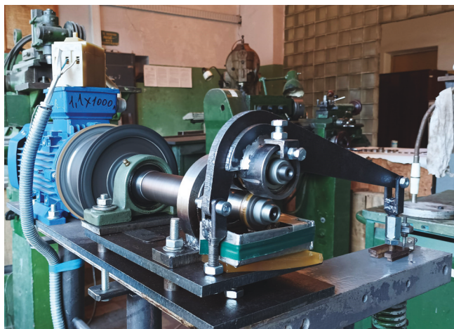
Рис. 6. Общий вид установки для испытания образцов на контактную усталость
