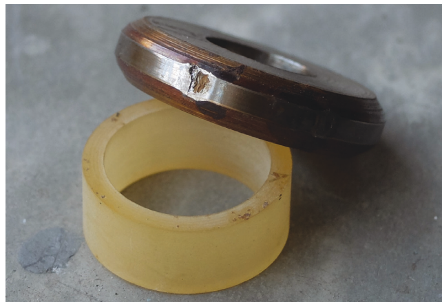
Рис. 7. Образец с контактно-усталостной выщербиной
