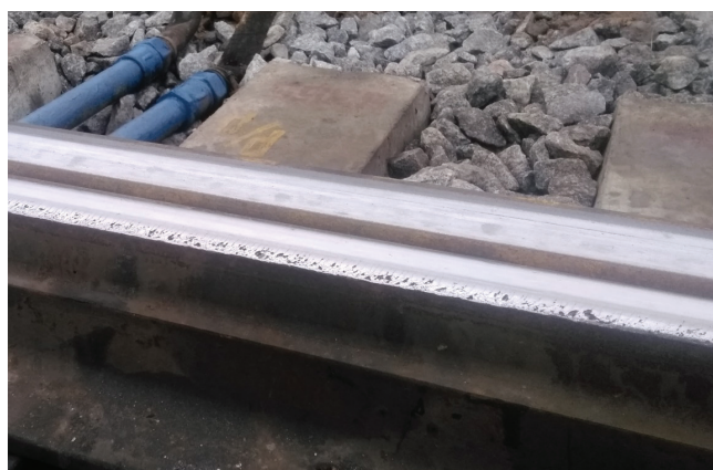
Рис. 3. Выкрашивание металла на рабочей поверхности острйка типа Р65 из-за воздействия колес с повышенной нагрузкой
