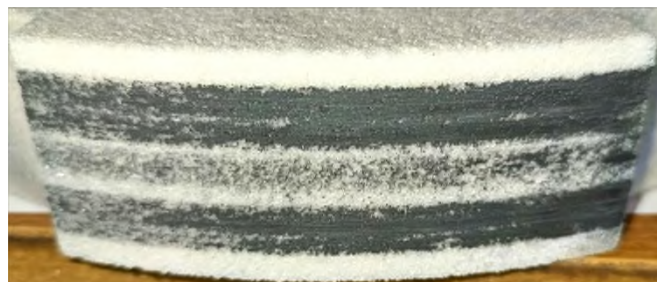
Рис. 9. Периферия прерывистого шлифовального круга марки 25A F60 K7 V35
