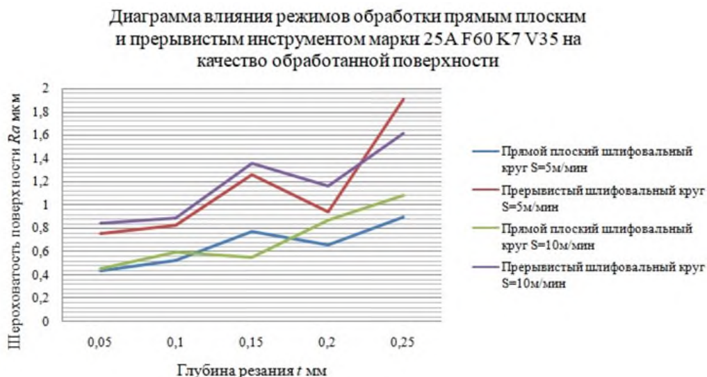
Рис. 8. Влияние режимов обработки прямым плоским и прерывистым шлифовальным кругом марки 64CF60 K7 V35 на качество обработанной поверхности
