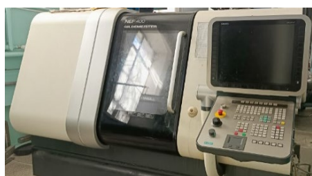
Рис. 2. Токарный обрабатывающий центр DMG NEF400
