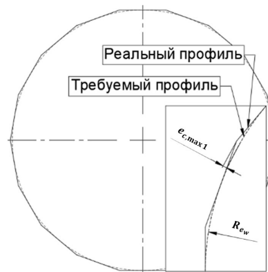
Рис. 1. Огранка, формируемая в процессе ортогональной токарно-фрезерной обработки
