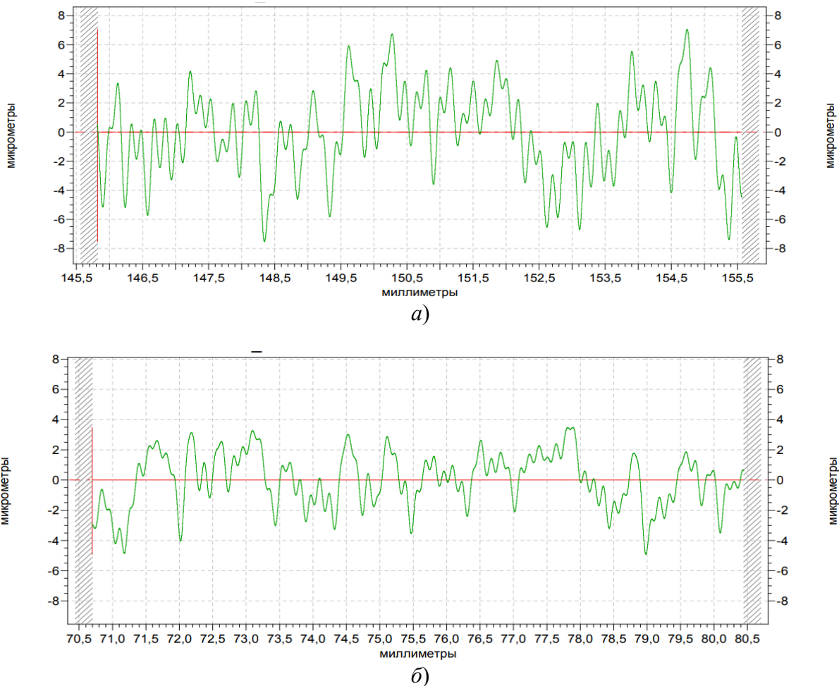
Рис. 6. Профилограммы исходной (а) и упрочненной (б) поверхностей при реверсивном ППД (при базовых режимах обработки)
